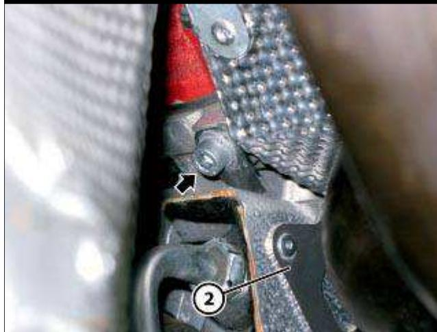
● 将隔热罩 (2) 动力转向泵上，并拧紧指示的螺钉紧固。
